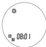
Рисунок 11. Индикация программирования 2-х периодов для выходных дней
