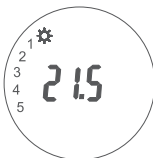
Рисунок 9. Установка температуры для периода времени
